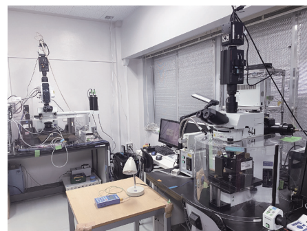
図：顕微鏡企業と共同で開発した線虫行動追尾装置や神経活動の計測装置
